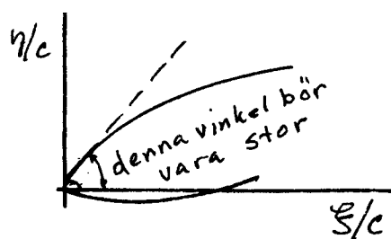
Fig.2 Utseende av profilnos för lågt R_{krit} .
